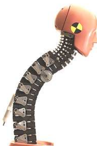
Abb. 2: komplex detaillierte Wirbelsäule BioRID2
