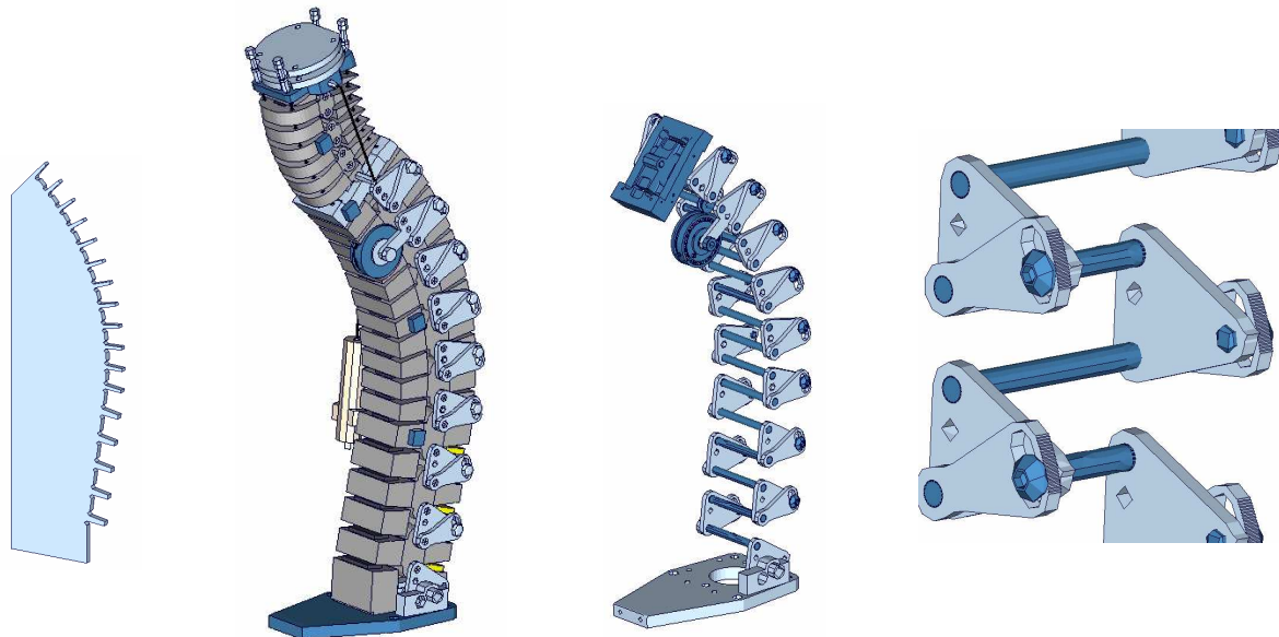
Abb. 8: Einstellschablone, Wirbelsäule, Leiterstruktur und Bolzenverbindung mit Einstellmöglichkeit der Krümmung des BioRID2
