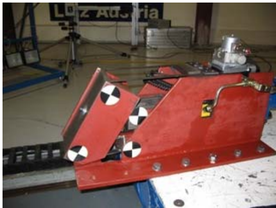
Abbildung 2: Prinzipskizze und Versuchsaufbau (Quelle: DSD) für den Intrusionsmechanismus am linken Bein des Fahrers.
